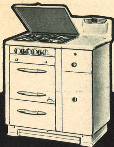
B 1 - GENEVÉE " Gazelle " Dim. ext. (L×P×H) 740×600×805 Dim. four (L×P×H) 300×450×255 Veilleuse centrale d'interallumage des brûleurs du dessus. Four à moufle mobile. Grilloir double par contact et par rayonnement avec grill à hauteur réglable. Etuve chauffe-plats et armoire à casseroles.
